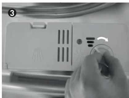
❶ Pour ouvrir le distributeur, tournez le bouchon dans le sens indiqué par la flèche « open » (gauche) et retirez-le.
