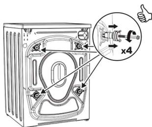
Dévissez les 4 vis dans le sens inverse des aiguilles d'une montre avec une clé appropriée.
