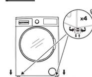
N'installez jamais votre lave linge sur un tapis (ou sur une surface semblable) qui obstruerait le passage de l'air de ventilation dans le bas. Pour assurer un fonctionnement silencieux et sans vibration de votre lave linge, positionnez-le sur une surface ferme et non glissante (exclure les planchers en bois).
