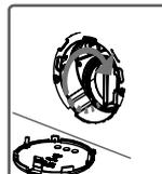
• Lors de la fermeture du couvercle de la pompe, assurez-vous que les pièces de la face interne du couvercle correspondent aux trous sur le côté du panneau avant.
