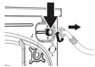
• Branchez à un robinet 3/4 (20x27) l'autre raccord (droit) en intercalant le joint avec filtre. Serrez à main la partie en plastique du tuyau.
