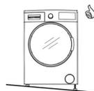
Il est impératif de mettre votre lave linge de niveau. Pour cela, il sera nécessaire d'utiliser un niveau à bulle.
