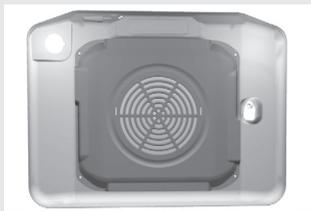
La paroi arrière du four est revêtue d'une **plaque catalytique** qui doit être démontée ou remplacée exclusivement par un professionnel qualifié.
