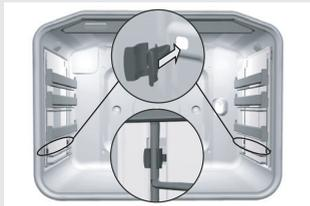
Lorsque vous installez les glissières télescopiques totalement extensibles et les parois amovibles, placez dans les trous inférieurs situés sur les parois inamovibles du four les clips fournis, puis insérez les tiges du châssis dans ces clips. Ces derniers servent à maintenir le châssis en fil bien en place.
