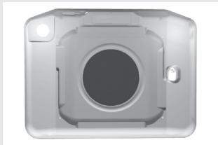
Le filtre antigraisse situé sur la paroi arrière du four protège le ventilateur, les résistances et les parois du four des éclaboussures de graisse. Insérez toujours le filtre pendant la cuisson de la viande, mais enlevez-le pour cuire les pâtisseries. L'utilisation du filtre pendant la cuisson des gâteaux peut entraîner de mauvais résultats.
