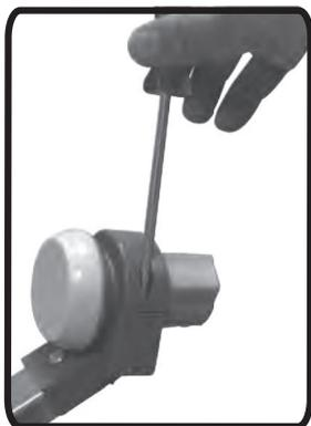
Monter la première partie du support du convertisseur sur le bras, puis fixer le convertisseur en vissant la seconde partie du support.
