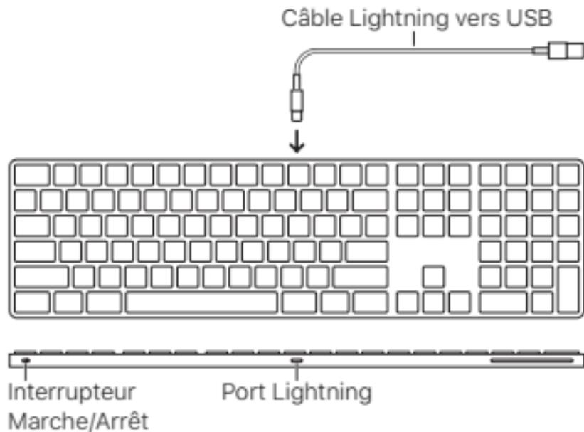
Pour jumeler votre clavier Magic Keyboard avec votre Mac, utilisez le câble Lightning vers USB fourni avec votre clavier Magic Keyboard. Branchez l'extrémité Lightning sur le port correspondant de votre clavier et l'extrémité USB sur un des ports USB de votre Mac. Allumez le clavier à l'aide de son interrupteur marche/arrêt l'indicateur passe au vert.
