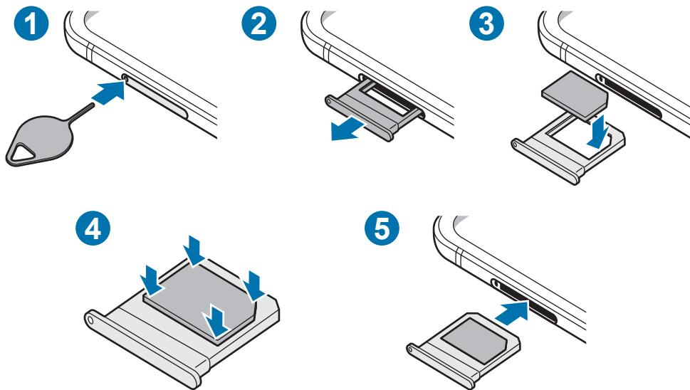
**1** Insérez l'outil de retrait à l'endroit prévu à cet effet sur le compartiment pour le déverrouiller.
