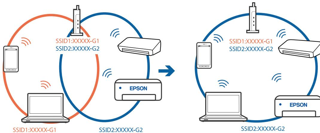
□ Exemple de connexion à des SSID de différentes plages de fréquences
