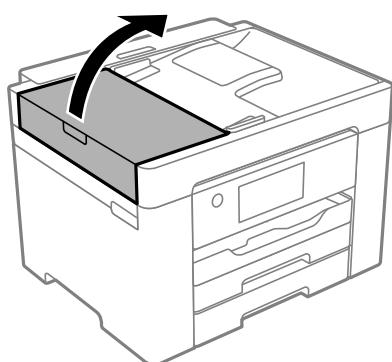
2. Nettoyez le rouleau et l'intérieur de l'ADF à l'aide d'un chiffon doux et humide.
