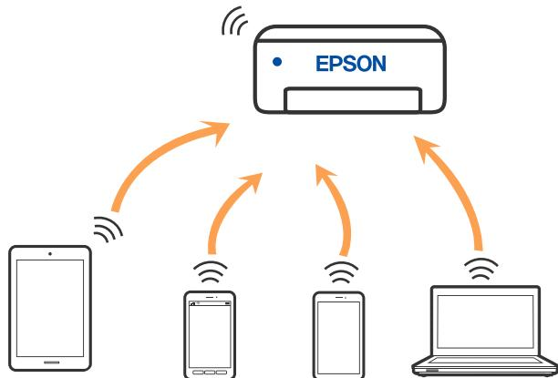
L'imprimante peut être connectée simultanément via Wi-Fi ou Ethernet et Wi-Fi Direct (PA unique). Cependant, si vous initiez une connexion réseau en mode Wi-Fi Direct (PA unique) lorsque l'imprimante est connectée en Wi-Fi, le Wi-Fi est temporairement déconnecté.
