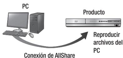
1. Conecte el producto, su PC o el teléfono móvil compatible con DLNA a la misma red inalámbrica.
