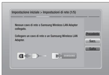
4. Collegare il cavo di rete o inserire l'adattatore LAN wireless Samsung.
