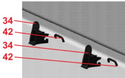
☞ Clipsen Sie die beiden Einführhilfen\* **34**, mit der Aussparung nach oben auf die beiden ISOFIX-Befestigungspunkte **42**.
