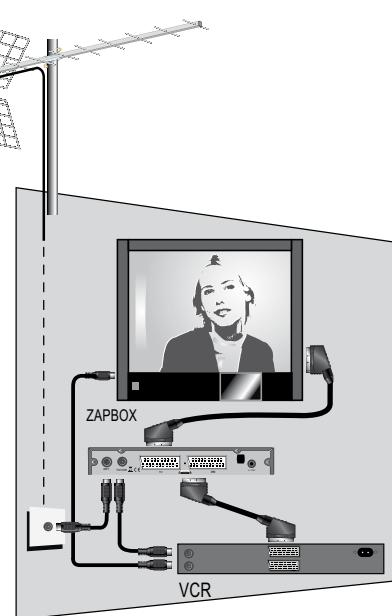
Om een tape te bekijken, plaatst u de adapter in stand-by en start eenvoudig de tape. De videorecorder krijgt automatisch de bovenhand over de adapter. Als dat niet het geval is, druk dan op de TV/VCR-toets op de afstandsbediening van uw videorecorder.
