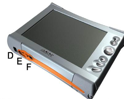
**D. Port USB 2.0 :** insérez la fiche mini jack du câble USB ici et branchez l'autre extrémité au port USB de l'ordinateur. (compatible USB 1.1).
