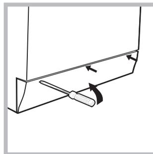
1. Ta bort skyddspanelen på tvätt- och torkmaskinens framsida med hjälp av en skruvmejsel (se figur).
