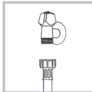
1. Fastgør forsyningsslangen ved at skru den fast til en koldt vandshane med det gevindskårne 3/4" mundstykke (se illustrationen). Inden tilslutningen skal vandet løbe, indtil det er klart.
