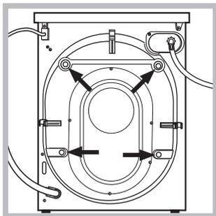
3. Ta bort de 4 skruvarna, som skyddat maskinen under transporten, samt gummidelen med dess avståndsbricka, som sitter på bakstycket (se figur).
