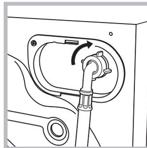
2. Das andere Ende des Schlauches an den oben rechts am Rückteil des Waschtrockner befindlichen Wasseranschluss anschließen (siehe Abbildung).
