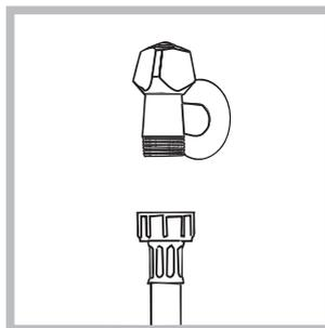
1. Kople inntaksslagen ved å skru den til en kaldtvannskran med gjengetut  $\frac{3}{4}$  gass (se figur).
