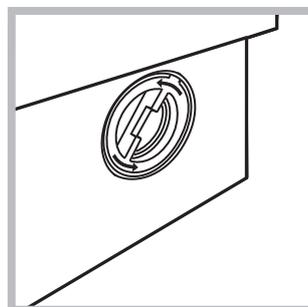
2. Lossa locket genom att vrida det moturs (se figur): Det är normalt att lite vatten rinner ut.
