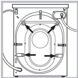
3. Die 4 Transportschutzschrauben herausschrauben und die an der Geräterückwand befindlichen Distanzstücke aus Gummi entfernen (siehe Abbildung).
