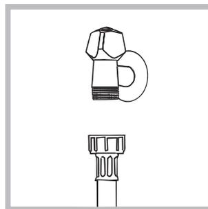
1. Anslut inloppsslangens ände och skruva fast den på en kallvattenkran som har en öppning med  $\frac{3}{4}$  gasgänga (se figur). Innan du ansluter slangen ska du låta vattnet rinna tills det är helt klart.
