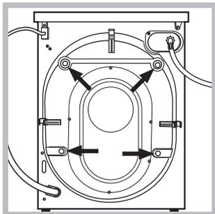
3. Fjern de 4 skruer til beskyttelse under transporten, samt gummidelen og det tilhørende afstandsstykke anbragt bagpå (se illustrationen).
