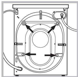
3. Fjern 4 beskyttelsesskruer (som brukes under transport) og gummitetningen med tilhørende avstandsstykke, som befinner seg på baksiden av apparatet (se figur).
