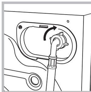
2. Tilkople inntaksslagen til vaskemaskinen-tørketrommelene ved å skru den på tilhørende vanninntak på apparatet, som befinner seg øverst til høyre på apparatets bakside (se figur).
