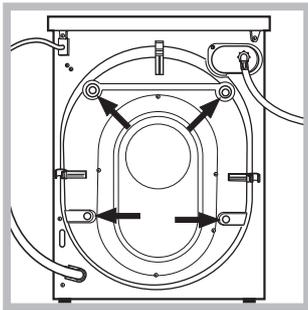
3. Poista **4** kuljetuksen suojaruuvia sekä tiiviste vastaavan välikappaleen kanssa, jotka sijaitsevat takaosassa (katso kuvaa).
