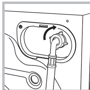
2. Anslut inloppsslangen till tvätt- och torkmaskinen genom att skruva fast den till det avsedda vattenuttaget i den bakre delen uppe till höger (se figur).
