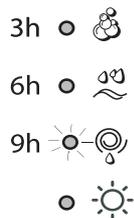
Efter en stund kommer kontrollampan att börja blinka för att visa hur lång tid som återstår:
