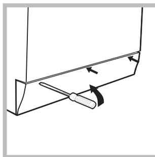
1. Ved bruk av en skrutrekker, fjernes panelet på nedre forside av vaskemaskinen-tørketrommelene (se figur);
