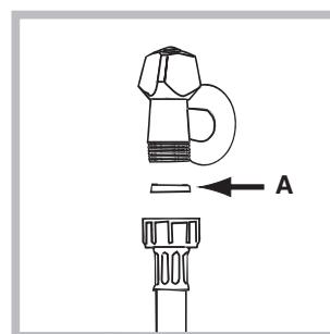
1. Legen Sie die Gummidichtung A in das Anschlussstück des Zulaufschlauches ein und drehen Sie dieses an einen mit Gewindeanschluss von 3/4 G versehenen Kaltwasserhahn (siehe Abbildung). Lassen Sie das Wasser vor dem Anschluss so lange auslaufen, bis klares Wasser austritt.
