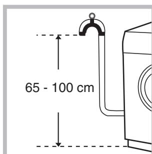
Conecte el tubo de descarga, sin plegarlo, a un desagüe de pared ubicado a una distancia del piso comprendida entre 65 y 100 cm;
