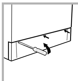
1. αφαιρέστε το ταμπλό κάλυψης στο πρόσθιο πλευρό του πλυντηρίου με τη βοήθεια ενός κατσαβιδιού (βλέπε εικόνα)
