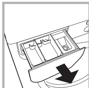
Heben Sie die Schublade leicht an und ziehen Sie sie nach vorne hin heraus (siehe Abbildung). Spülen Sie diese regelmäßig unter fließendem Wasser gründlich aus.
