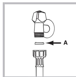
1. Introduzca la junta A en el extremo del tubo de alimentación y enrósquelo a un grifo de agua fría con boca rosada de 3/4 gas (*véase la figura*). Antes de conectarlo, haga correr el agua hasta que salga limpia.
