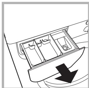
Extraiga el contenedor tirando hacia fuera (*ver la figura*). Lávolo debajo del agua corriente, esta limpieza se debe realizar frecuentemente.
