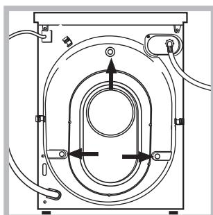
3. Die 3 Transportschutzschrauben ausschrauben und das an der Rückwand befindliche Gummiteil nebst entsprechendem Distanzstück abnehmen (siehe Abbildung).
