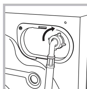
2. Schließen Sie das andere Ende des Schlauches an den oben rechts am Rückteil des Waschvollautomaten befindlichen Wasseranschluss an (siehe Abbildung).
