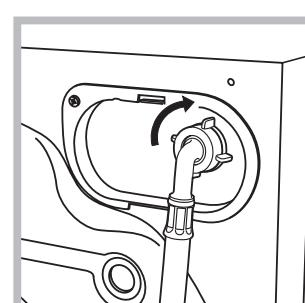
1. Εισάγετε την τσιμούχα Α στο άκρο του σωλήνα τροφοδοσίας και βιδώστε τη μια βρύση κρύου νερού με στόμιο σπιερώματος 3/4 gas (βλέπε εικόνα). Πριν την σύνδεση αφίστε το νερό να τρέξει μέχρι αυτό να είναι διαυγές.
