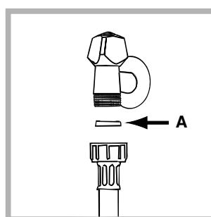
1. Montez le joint A sur l'extrémité du tuyau d'alimentation et vissez-le à un robinet d'eau froide à embout fileté 3/4 gaz (voir figure). Faites couler l'eau jusqu'à ce qu'elle soit limpide et sans impuretés avant de raccorder.
