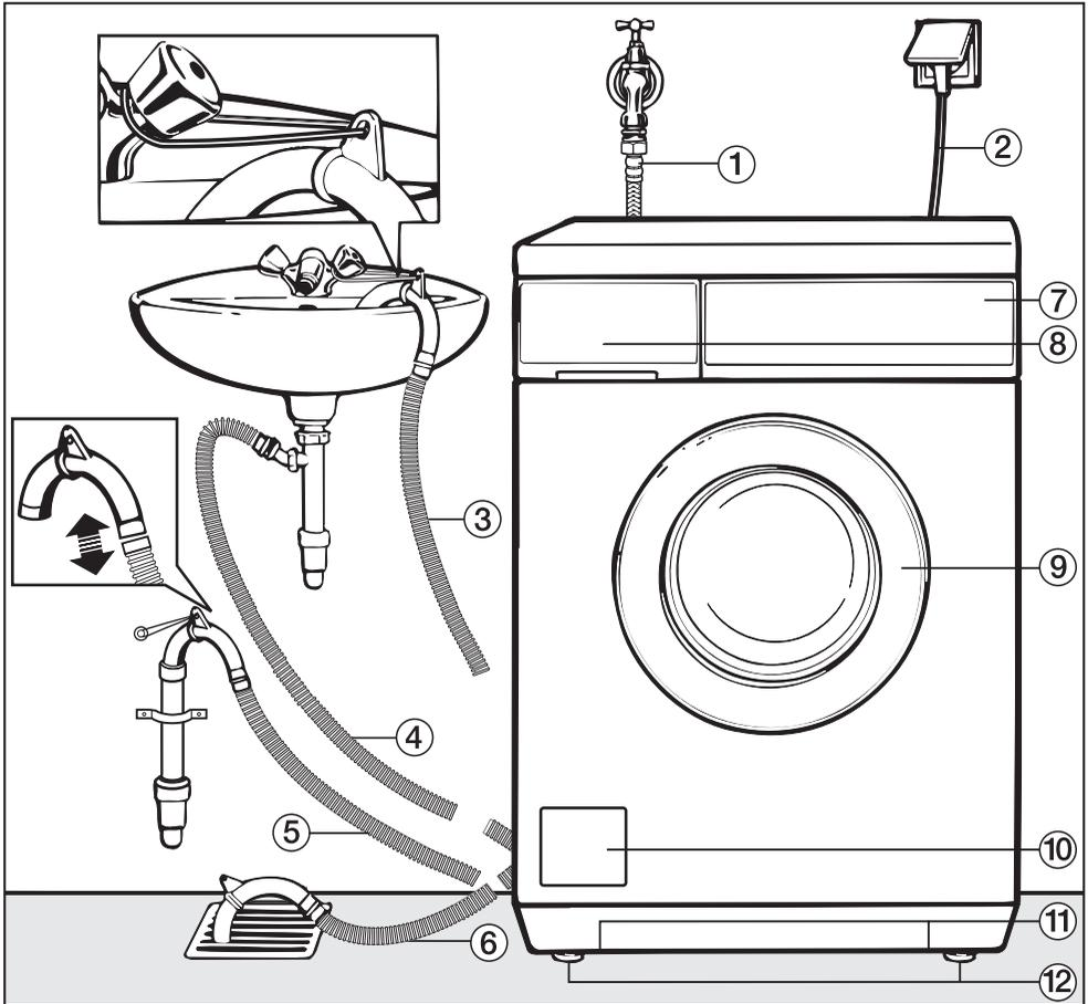
① Tuyau d'arrivée d'eau (métallique waterproof, tuyau à armature métallique)
