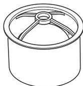
Retirer le filtre à air et contrôler qu'il est intact. S'il présente des défauts, remplacer par un filtre à air neuf.
