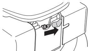
Dévisser le couvercle de remplissage d'huile et contrôler le niveau d'huile sur la jauge d'huile située sur le couvercle.
