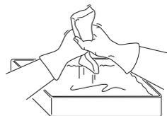
Monter le filtre sur le carter de filtre en veillant à ce que le bord du filtre recouvre le bord du carter pour assurer une protection étanche.
