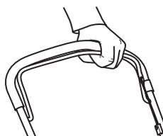
Saisir ensuite la poignée de démarrage de la main droite et tirer lentement sur le lanceur jusqu'à ce qu'une résistance se fasse sentir (les cliquets d'entraînement grippent), puis tirer énergiquement et rapidement sur le lanceur.
