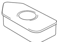
Laver le filtre avec un agent de nettoyage liquide et de l'eau. Une fois nettoyé, le filtre doit être huilé avec de l'huile moteur.
