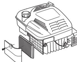
Retirer le filtre à air et contrôler qu'il est intact. S'il présente des défauts, remplacer par un filtre à air neuf.
