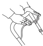
Le frein moteur doit toujours être réglé de manière à ce que le moteur s'arrête dans les 3 secondes.
