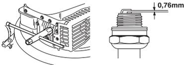
**REMARQUE!** Toujours utiliser le type de bougie recommandé! Une bougie incorrecte peut endommager le piston/le cylindre.
