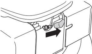
Toujours vider le réservoir de carburant avant de coucher la tondeuse sur le côté.
