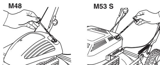
Le couvercle de remplissage d'huile doit être vissé à fond pour obtenir une mesure correcte du niveau d'huile.
