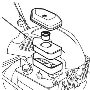
Retirer le couvercle et le canal d'air.
