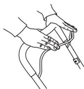
L'étrier de frein ne doit jamais être fixé de façon permanente dans la poignée lorsque la machine est en marche.
