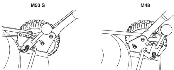
Ne pas régler la hauteur de coupe trop bas afin que la machine ne se cogne contre le sol en cas d'irrégularités de terrain.
