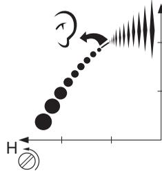
Le moteur ne doit pas être chargé lors du réglage du pointeau haut-régime H. Démontez l'équipement de coupe, l'écrou, la bride de support et le toc d'entraînement avant d'effectuer le réglage du pointeau haut-régime H.
