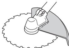
S'assurer que la protection est intacte et qu'elle ne présente pas de fissures. Remplacer la protection si elle a subi des coups ou si elle présente des fissures.
