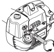
Donner les pleins gaz et tourner le pointeau haut-régime H très lentement dans le sens des aiguilles d'une montre jusqu'au ralentissement du moteur. Tourner ensuite le pointeau haut-régime H très lentement dans le sens inverse jusqu'à ce que le moteur tourne de manière irrégulière. Tourner ensuite légèrement le pointeau haut-régime H dans le sens des aiguilles d'une montre jusqu'à ce que le moteur tourne de manière régulière.
