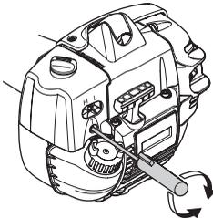
**IMPORTANT!** S'il est impossible de régler le régime de ralenti de manière à immobiliser l'équipement de coupe, contacter le revendeur ou l'atelier de réparation. Ne pas utiliser la machine tant qu'elle n'est pas correctement réglée ou réparée.
