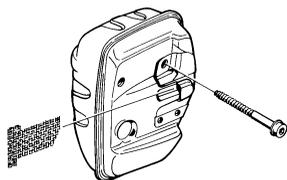
Sur les silencieux sans pot catalytique, la grille doit être nettoyée et si nécessaire remplacée une fois par semaine. Sur les machines dont le silencieux est muni d'un pot catalytique, la grille devra être inspectée et si nécessaire nettoyée une fois par mois. **Si la grille est abîmée, elle devra être remplacée.**
