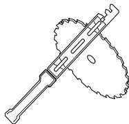
Inspecter l'équipement de coupe afin de détecter d'éventuels dommages ou fissures. Toujours remplacer un équipement de coupe endommagé.
