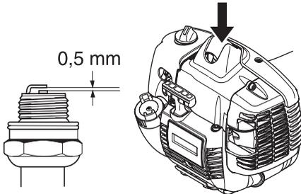
**REMARQUE!** Toujours utiliser le type de bougie recommandé! Une bougie incorrecte peut endommager le piston/le cylindre.
