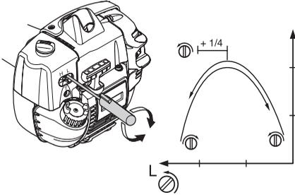
**REMARQUE!** Si l'équipement de coupe tourne au ralenti, tourner le pointeau de ralenti T dans le sens contraire des aiguilles jusqu'à l'arrêt de l'équipement de coupe.
