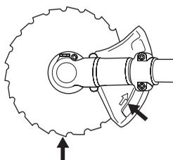
L'usure du verrouillage nylon du contre-écrou ne doit pas être telle qu'il peut se visser à l'aide des doigts. Le verrouillage doit résister à 1,5 Nm au moins. Remplacer le contre-écrou après une dizaine de serrages.
