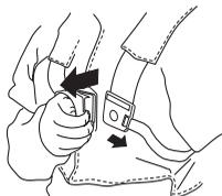
S'assurer du bon positionnement des bretelles du harnais. Quand le harnais et la machine sont ajustés, contrôler le bon fonctionnement du dispositif de libération rapide du harnais.
