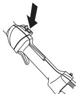
**REMARQUE!** L'interrupteur d'arrêt se remet automatiquement en position de démarrage. Toujours retirer le chapeau de bougie de la bougie lors du montage, contrôle et/ou entretien, afin d'éviter tout démarrage accidentel.
