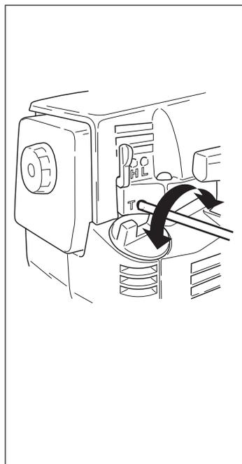
**AVERTISSEMENT!** S'il est impossible de régler le régime de ralenti pour immobiliser l'équipement de coupe, contacter le revendeur/atelier de service. Ne pas utiliser la machine tant qu'elle n'est pas correctement réglée ou réparée.
