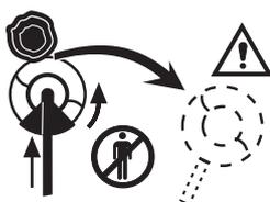
• Les machines équipées d'une lame d'éclaircissage ou à herbe peuvent projeter violemment sur le côté dur. La lame peut sectionner les bras et les jambes. Toujours maintenir les personnes et les animaux à au moins 15 mètres de la machine.
