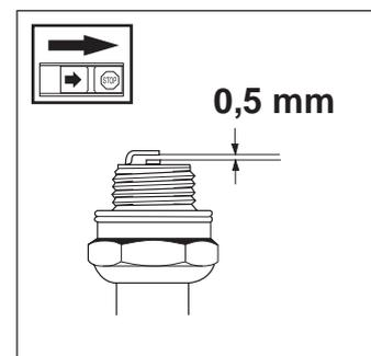
Si la puissance de la machine est réduite, si la machine est difficile à démarrer ou si le régime de ralenti n'est pas régulier, contrôler en premier lieu l'état de la bougie d'allumage, avant de prendre d'autres mesures.
