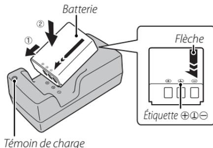
Cet appareil photo fonctionne avec une batterie rechargeable NP-85.
