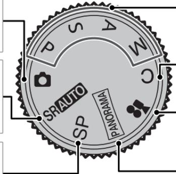
**P, S, A, M** : Sélectionnez l'un de ces modes pour disposer d'un contrôle total des réglages de l'appareil photo, y-compris l'ouverture (**M** et **A**) et/ou la vitesse d'obturation (**M** et **S**) (p. 27).
