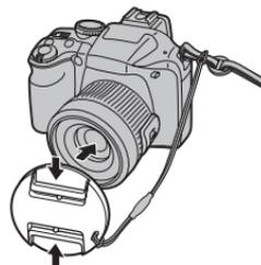
Pour éviter de perdre le capuchon de l'objectif, passez le cordon fourni à travers l'œillet (①) et fixez le capuchon de l'objectif à la dragonne (②).
