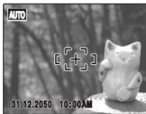
Dans la composition ci-dessus, les sujets sont en dehors du cadre AF. Si vous appuyez maintenant à mi-course sur le déclencheur, les sujets ne seront pas mis au point.
