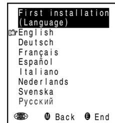
**2** Appuyer sur **▲/▼** pour choisir la langue souhaitée, puis sur **OK**. La page-écran "Première mise en service (Recherche automatique)" apparaît dans la langue sélectionnée.
