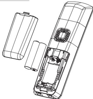
**!** *Utiliser uniquement des batteries rechargeables de caractéristiques identiques à celles fournies avec le produit. L'utilisation de piles non rechargeables ou non-conformes aux modèles préconisés risque d'endommager votre produit et est dangereuse pour la santé des personnes (se référer au chapitre 9 "Caractéristiques techniques").
