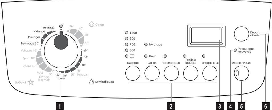
1. **Sélecteur de programmes** : Sur la position
