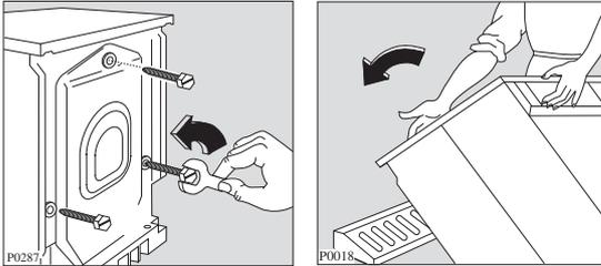
Appuyez l'appareil sur la partie arrière et mettez entre le sol et le lave linge une des cales en polystyrène.
