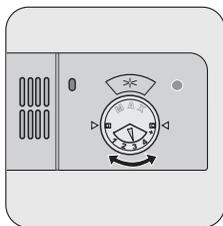
Le liquide de rinçage est réglé d'usine sur le niveau 3. Pour augmenter ou réduire le dosage, reportez-vous à "En cas d'anomalie de fonctionnement"
