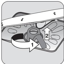
**3** Pour retirer les filtres B et C, tournez la poignée d'environ  $\frac{1}{4}$  de tour dans le sens contraire des aiguilles d'une montre.
