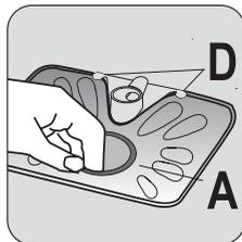
**5** Réinstallez le filtre plat (A) dans le fond de la cuve. Veillez à ce qu'il soit bien installé sous les deux rails (D).
