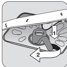
**6** Mettez le système de filtration en place. Bloquez-les en tournant la poignée dans le sens des aiguilles d'une montre jusqu'à la butée.
