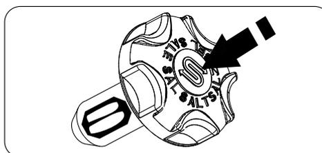
Le bouchon de réservoir de sel comporte en son centre un indicateur de salinité. Lorsqu'un repère **vert** n'est plus visible, la quantité de sel est insuffisante; vous devez remplir le réservoir.
