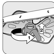
Tournez la poignée d' $\frac{1}{4}$  de tour dans le sens inverse des aiguilles d'une montre et retirez les filtres **B** et **C**.
