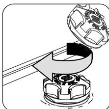
Revissez le bouchon dans le sens des aiguilles d'une montre jusqu'à ce qu'il se bloque en fin de course en émettant un clic.
