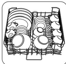
Chargement du panier supérieur. Les ustensiles légers (bols en plastique conçus pour être lavés en lave-vaisselle, etc.) doivent être placés dans le panier supérieur, de façon à ce qu'ils ne puissent pas bouger.
