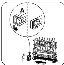
Glissez le panier dans sa position relevée et remettez les butées (A) dans la position d'origine.
