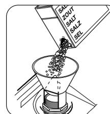
Remplissez complètement le réservoir de sel au moyen de l'entonnoir fourni avec le lave-vaisselle.
