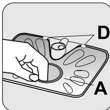
Remettez le filtre plat **A** dans le fond de la cuve et assurez-vous qu'il est correctement en place sous les deux guides **D**.
