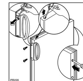
La réversibilité de la porte une fois effectuée, contrôlez que le joint magnétique adhère à la carrosserie. Si la température à l'intérieur de la pièce est trop basse (en hiver, par exemple), il se peut que le joint n'adhère pas parfaitement. Dans ce cas, si on ne veut pas attendre que le joint reprenne sa dimension naturelle après un certain temps, on pourra accélérer ce processus en chauffant la partie intéressée à l'aide d'un sèche-cheveux.
