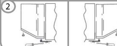
Entfernen Sie die Schutzkappen (A) und (B), lösen Sie die Schrauben und ziehen Sie die Stirnwand teilweise her aus.
