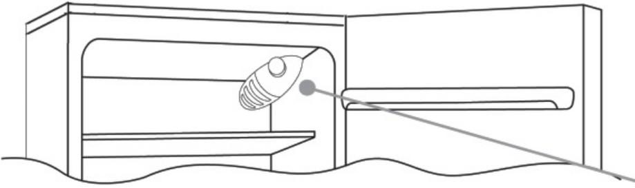
Laitteen säätöön tarkoitettu termostaattilaatikko sijaitsee jääkaappiosaston sisällä oikealla ylhäällä. Kun haluat tarkastaa, että laite toimii, varmista, että termostaattinappi ei ole asennossa "0".
