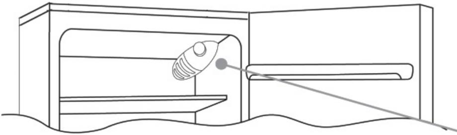
La caja del termostato que controla la aplicación se encuentra ubicada dentro del compartimento del frigorífico en la zona superior derecha. Para comprobar si la aplicación está funcionando, asegúrese de que la rueda del termostato no esté fijada en "0".
