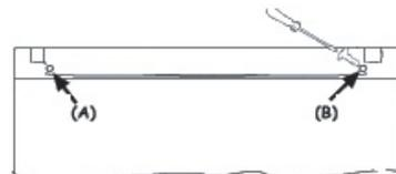
Выверните два винта, расположенные на задней стенке холодильника, и снимите верхнюю крышку холодильника
