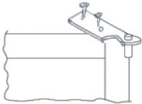
Ota vasen yläsarana laitteen mukana toimitettavasta välinepakkauksesta ja aseta se paikalleen.
