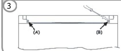
Bitte die Schrauben am rechten Türscharnier lösen, entfernen und das Scharnier abnehmen.
