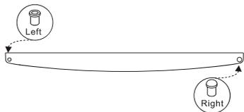
Schroef de scharnieren en deur vast. Werk hierbij van onder naar boven.
