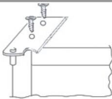
Wyciągnij zaślepkę umiejscowioną po lewej stronie drzwi i wtórz ją w otwór po wyjętym zawiasie, po prawej stronie drzwi.
