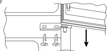
Draai de twee schroeven aan de achterzijde van de deur los en verwijder de bovenzijde.
