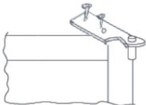
Przed przłożeniem drzwi na lewą stronę, obróć zawias w odwrotnym kierunku.
