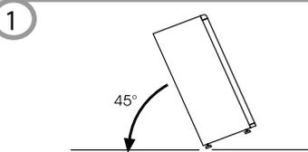
Saque la bisagra inferior, desatornillando las tuercas, sacando el enchufe y las arandelas y a continuación, saque la puerta inferior.
