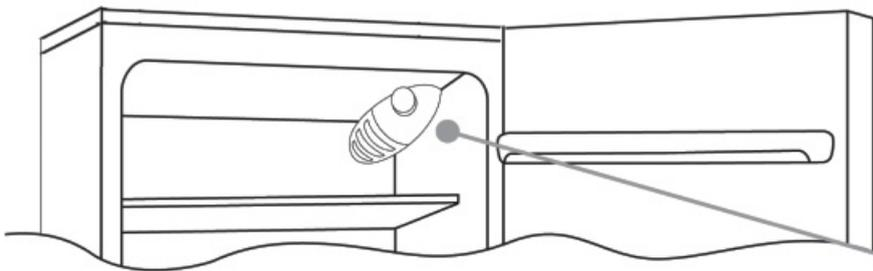
La scatola termostato per il controllo dell'apparecchio è collocata dell'interno della cella frigo in alto a destra. Per essere certi che l'apparecchio stia funzionando accertarsi che la manopola termostato non sia sulla posizione "0".
