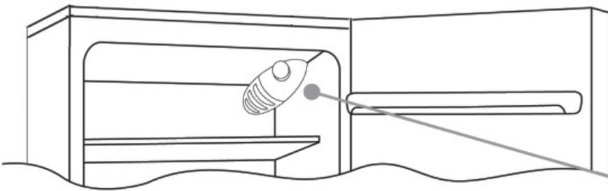
A caixa do termostato que controla o equipamento está localizada dentro do compartimento do frigorífico no lado superior direito. Para verificar se o equipamento está a funcionar, certifique-se de que o botão do termostato não está regulado para „0“.
