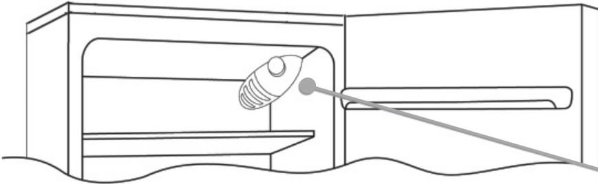
De thermostaat van het apparaat bevindt zich rechtsboven in het koelgedeelte. U kunt alleen controleren of het apparaat werkt als de thermostaatknop niet op 0 staat.
