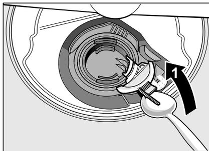
6. Vérifiez si la roue à aubes présente des corps étrangers et retirez-les le cas échéant.
