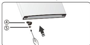
11. Changez les caches des trous de vis et vissez la plaque de finition centrale de gauche à droite (comme indiqué dans le schéma ci-dessous).
