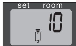
J: Quando appare la spia FUEL, verranno mostrati sul display informativo i minuti di funzionamento che ancora rimangono alla stufa in base alla quantità di combustibile rimasta nel serbatoio.
