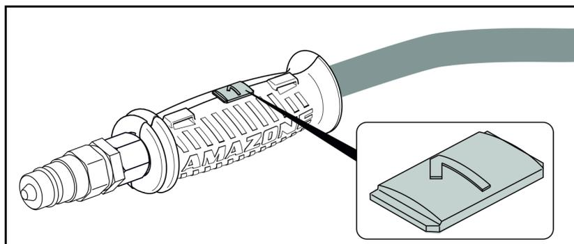
Des autocollants correspondant aux repères sont collés sur la machine, expliquant les fonctions hydrauliques correspondantes.
