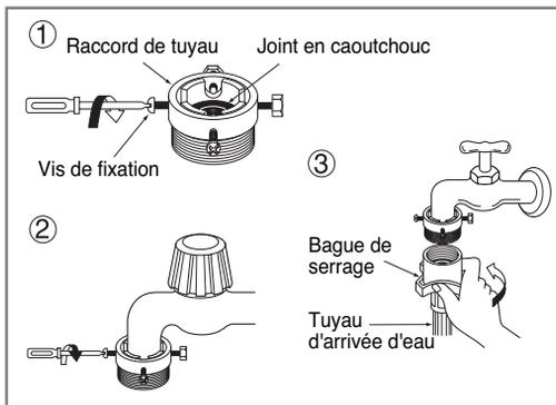
1. Dévissez la bague de serrage et les 4 vis de fixation.
