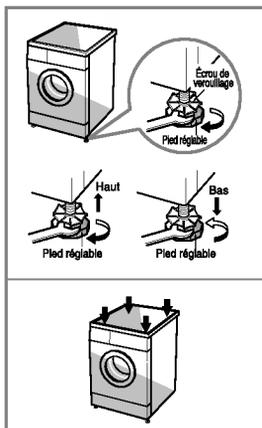
2. Si le sol est inégal, régler les pieds de mise à niveau (ne pas insérer de cales de bois, etc ... sous les pieds). S'assurer que les quatre pieds sont stables et reposent sur le sol . Vérifier ensuite que l'appareil est parfaitement à niveau (utiliser un niveau à bulle d'air).
