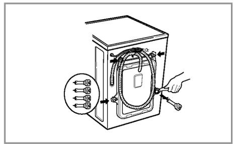
1. Les 4 vis spéciales sont serrées pour prévenir tous dommages internes pendant le transport. Avant de faire fonctionner la machine à laver, enlever les vis ainsi que les rondelles en caoutchouc.
