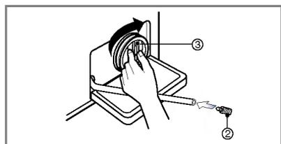
4. Après le nettoyage, faire tourner le filtre de la pompe (③) dans le sens des aiguilles d'une montre et insérer le bouchon de purge (②) pour le remettre en place. Fermer le capot du couvercle inférieur.
