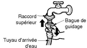
• Si le diamètre du robinet est trop grand, déposer la bague de guidage.
