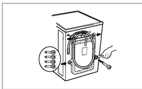
1. Les 4 vis spéciales sont serrées pour prévenir tous dommages internes pendant le transport. Avant de faire fonctionner la machine à laver, enlever les vis ainsi que les rondelles en caoutchouc.
