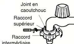
3. Brancher le tuyau d'arrivée d'eau au raccord intermédiaire tout en poussant la bague de guidage vers le bas.
