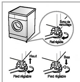
2. Si le sol est inégal, régler les pieds de mise à niveau (ne pas insérer de cales de bois, etc ... sous les pieds). S'assurer que les quatre pieds sont stables et reposent sur le sol. Vérifier ensuite que l'appareil est parfaitement à niveau (utiliser un niveau à bulle d'air).
