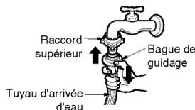
• Si le diamètre du robinet est trop grand, déposer la bague de guidage.
