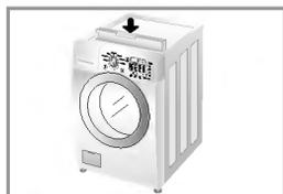
1. Pour réduire les vibrations et les bruits excessifs, installer la machine sur un sol stable et de niveau, de préférence dans un coin de la pièce.
