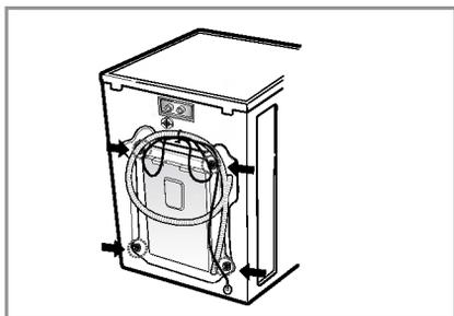
1. Les 4 vis spéciales sont serrées pour prévenir tous dommages internes pendant le transport. Avant de faire fonctionner la machine à laver, enlever les vis ainsi que les bords en caoutchouc.
