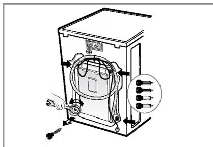
3. Enlever les 4 vis ainsi que les bords en caoutchouc en tordant légèrement la bonde. Garder les 4 vis et la clé pour une utilisation future.
