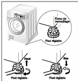
2. Si le sol est inégal, régler les pieds de mise à niveau (ne pas insérer de pièces de bois, etc ... sous les pieds). S'assurer que les quatre pieds sont stables et reposent sur le sol et vérifier ensuite que l'appareil est parfaitement de niveau (utiliser un niveau à bulle d'air).
