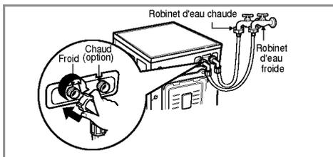
► La pression d'alimentation d'eau doit être comprise entre 30kPa et 1000kPa (0,3~10kgf/cm<sup>2</sup>).
