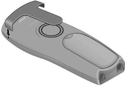
Placer le clip ceinture à l'arrière du combiné et appuyer jusqu'à ce que les « ergots » disposés latéralement s'enclipsent dans les trous.
