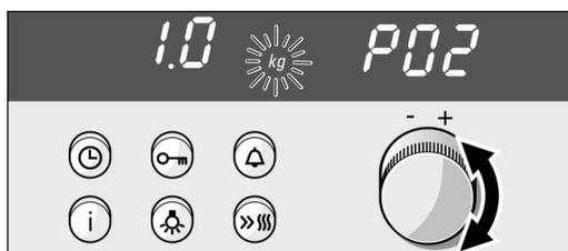
5. A l'aide du bouton rotatif, programmez le poids. Le four se met en marche quelques secondes plus tard. La durée s'écoule visiblement à l'affichage.
