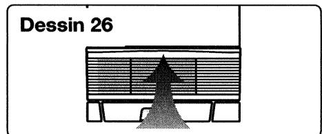
**IMPORTANT :** Lors du remontage du condenseur, maintenez le condenseur **plaqué au fond de son logement** pendant l'opération de verrouillage.
