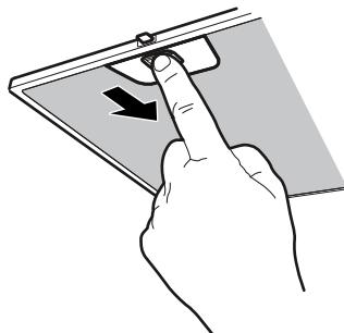
2. Metallfettfilter aus der Halterung herausnehmen.
