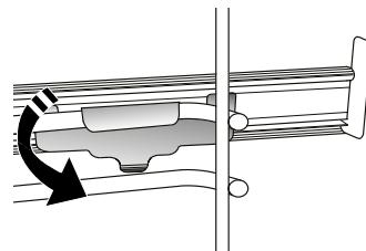
Nota: Las guías deslizantes se pueden montar en cualquier nivel.
