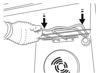
**3.** Para reposicionar a resistência, levante-a, puxando ligeiramente na sua direção, e certifique-se de que fica assente nos suportes laterais.
