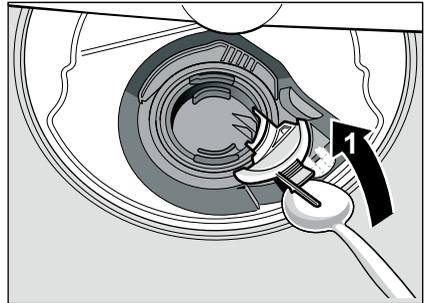
6. Vérifiez si la roue à aubes présente des corps étrangers et retirez-les le cas échéant.
