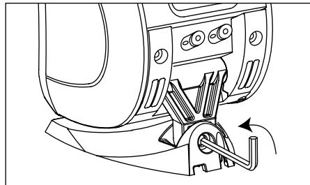
2. Utilisez la clef hexagonale fournie sous la base de Sib pour dévisser le socle et le séparer de l'enceinte.
