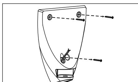
4. Placez le socle contre le mur et repérez les zones de perçage pour les trois vis de fixation fournies.
