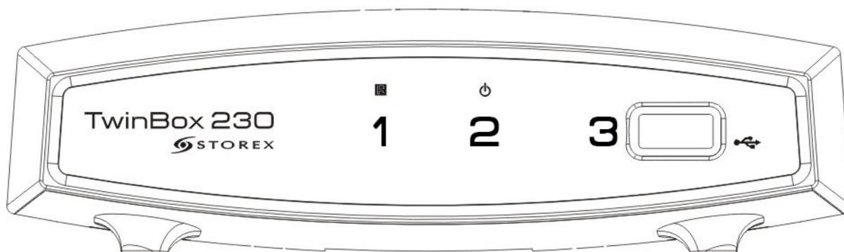
1. **RÉCEPTEUR INFRA ROUGE** : Permet de recevoir le signal de la télécommande.
