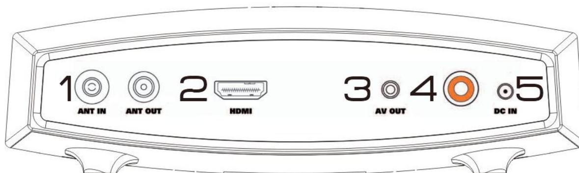
1. **ANTENNA IN** : Pour connecter un câble antenne de la prise murale à la TwinBox 230.
