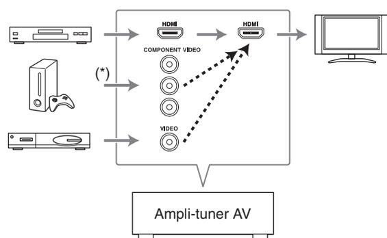
Si vous avez raccordé votre téléviseur à l'ampli-tuner AV à l'aide d'un câble HDMI, vidéo composite et vidéo composant peuvent être converties et restituées par HDMI OUT MAIN.
