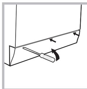
3. tire o painel de cobertura da parte dianteira da máquina de lavar roupa com ajuda de uma chave de fendas (veja a figura).
