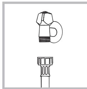
1. Conectar el tubo de tubo enroscándolo a un grifo de agua fría con la boca rosca de 3/4 gas (ver la figura). Antes de conectarlo, haga correr el agua hasta que esté limpia.
