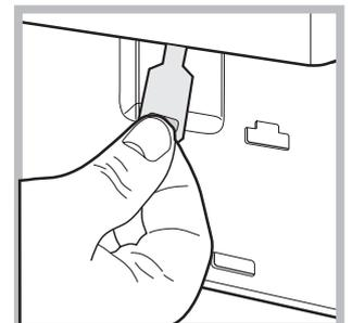
4. se servir de la languette indiquée, tirer vers soi jusqu'à ce que le tirant en plastique se dégage de son cran d'arrêt; tirer ensuite vers le bas et ouvrir l'hublot en même temps.
