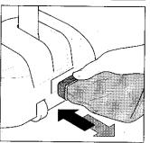
$\Delta$  Retournez l'appareil et retirez les deux cales  $\bf 15$  en faisant tourner une des brosses rotatives  $\bf 10$  dans les deux sens.
