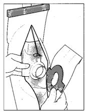
Retirez l'adhésif du ressort 20. Accrochez une extrémité du ressort au crochet 2 et l'autre extrémité à l'oeilleton 6 du sac 21/21a.
