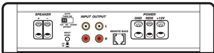
**Sélection de Mise sous Tension Automatique :** La série IX est dotée de trois modes différents de mise sous tension automatique pouvant être sélectionnés au panneau d'extrémité de l'amplificateur : +12V, DC Offset (décalage c.c.) et Audio. L'utilisation du mode DC Offset ou Audio permet à la borne REM d'avoir une sortie de +12 V pour des amplificateurs supplémentaires.
