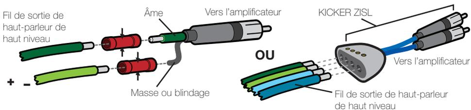
Installez un fusible dans un rayon de 45 cm (18 po) de la batterie directement sur le câble d'alimentation raccordé à votre amplificateur. Installez un fusible seconde dans les 18 "(45cm) de l'amplificateur. Si vous devez retirer l'amplificateur après l'avoir installé dans le véhicule, débranchez toujours le fil de masse en dernier, en procédant à l'opposé de l'installation.
