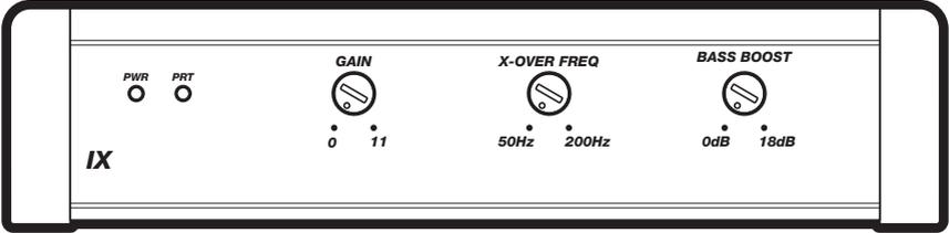
**Eingangsverstärkungsregler:** Der Eingangsverstärkungsregler ist kein Lautstärkereglер. Er passt den Ausgang des Autoradios an den Eingangspegel am Verstärker an. Stellen Sie das Autoradio auf etwa 3/4 der Lautstärke ein (wenn es also bis 30 geht, wählen Sie 25). Drehen Sie dann langsam den Verstärkungsregler am Verstärker (im Uhrzeigersinn), bis Sie eine hörbare Verzerrung feststellen. Drehen Sie ihn dann wieder etwas zurück.
