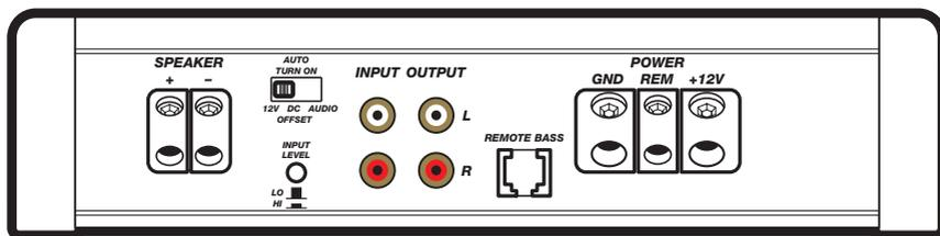
**Selección de Encendido Automático:** La serie IX ofrece tres modalidades de encendido automático que se pueden seleccionar en el panel de extremo: +12V, compensación de CC y audio. Las modalidades de audio o compensación de CC dan +12V a la terminal REM para encender otros amplificadores.
