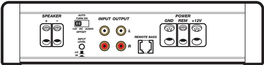
**Automatische Einschaltung:** Die IX-Serie bietet drei verschiedene automatische Einschaltmethoden, die an der Endplatte gewählt werden können: +12V, DC Offset und Audio. Wenn Sie „DC Offset“ oder „Audio“ verwenden, wird am REM-Terminal +12V für das Einschalten weiterer Verstärker bereit gestellt.
