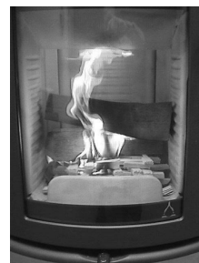
III.4 : Chiusura presa dell'aria primaria
