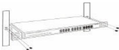
Figure 2. Installation du Switch dans un rack
